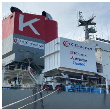
船上CO2回収装置と “CC-Ocean” (Carbon Capture on the Ocean) プロジェクトロゴ
